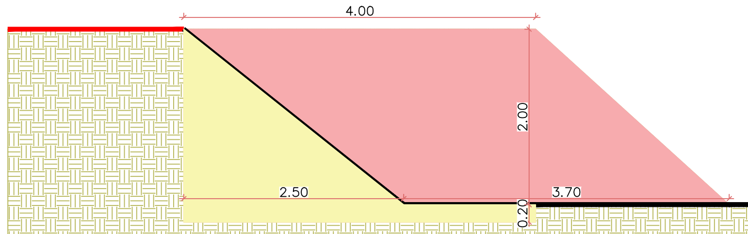
SEÇÃO TIPO - CORTE E ATERRO 4+480 ATÉ 4+520 SEM ESCALA
